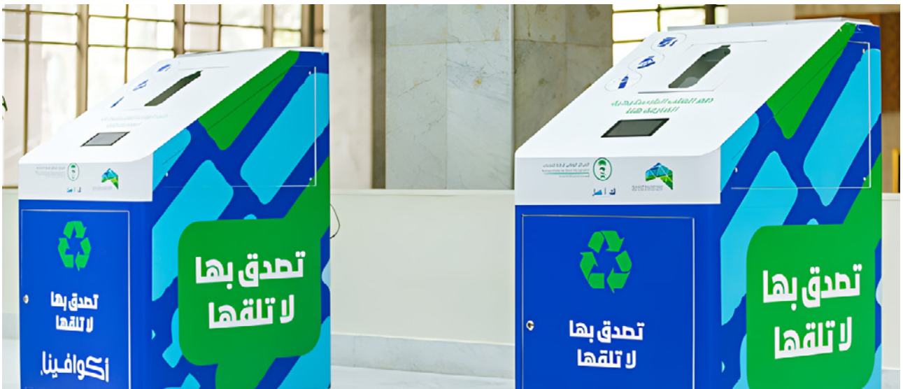
تعمل الحاويات الذكية العاملة بالطاقة الشمسية على فرز وفصل الزجاجات البلاستيكية الفارغة عن باقي النفايات لتسهيل وتسريع عملية الجمع.
